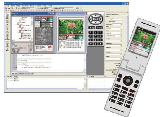
なる。制作者はBML編集とともに瞬時にデバッグとプレビューが行えることになり、実際の「見え方」を確認しながら、内部メモリや変数などのリアルタイム表示内容を確認し、さまざまな面から問題点の解消作業ができる。
